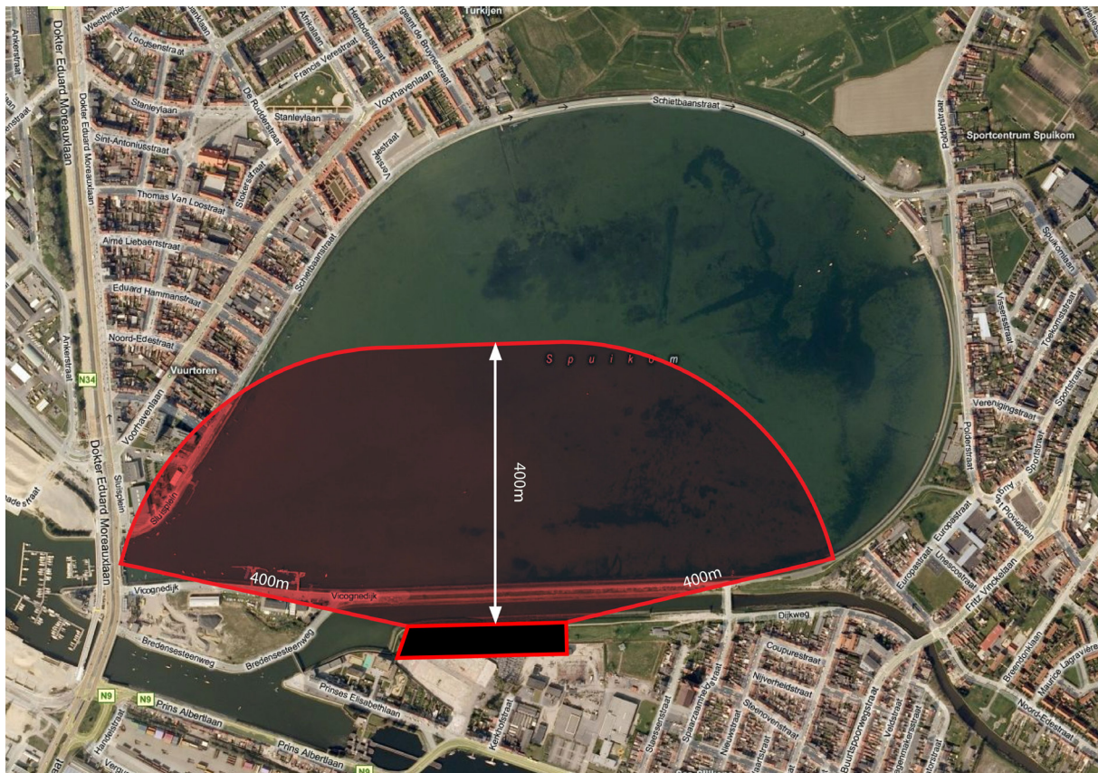
Invloedsfeer van een bouwhoogte van 40 m op het windklimaat in de Spuikom
